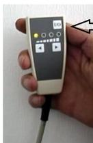
Durch erneutes Betätigen der I/O-Taste wird der Unterdruck abgeschaltet. Anschließend wird automatisch ausgeblasen.
